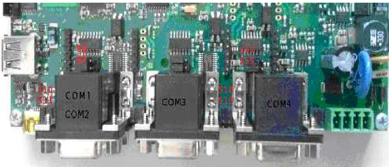
Figura 1 Riferimenti jumper per configurazione porte seriali
