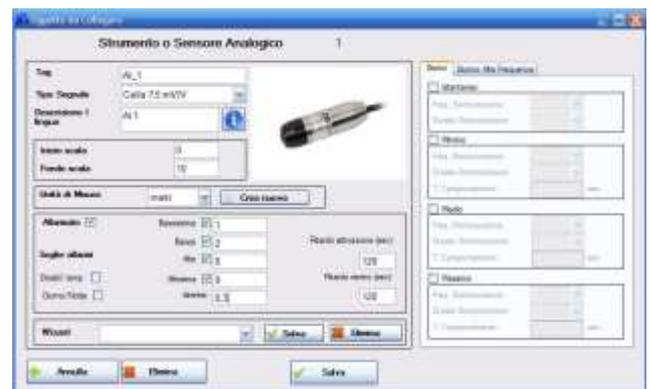
**Figura 4-5: Esempio di configurazione canale analogico cablato**
