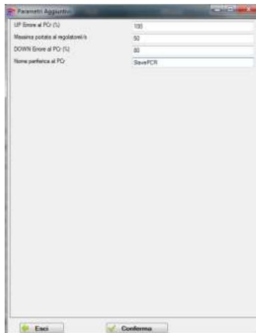
**Figura 4-25: Parametri aggiuntivi del regolatore in modalità Closed Loop (Punto critico)**
