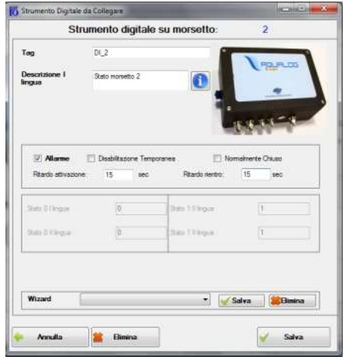
**Figura 4-7: Esempio configurazione ingresso digitale**
