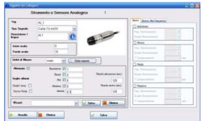
Figura 4-1: Esempio di configurazione canale analogico cablato
