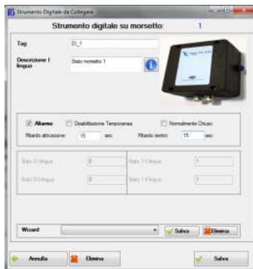
Figura 4-3: Esempio configurazione ingresso digitale
