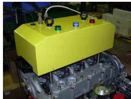
Modulo contenente i dispositivi di controllo e le telecamere digitali per la lettura dei codici sugli iniettori.
