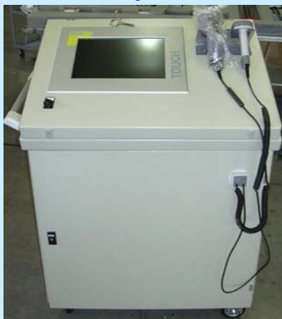
Quadro elettrico completo di PC industriale e PLC.
